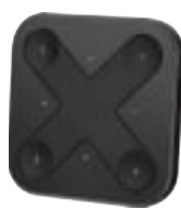
Xpress - włącznik 4 sceny/grupy, sterowanie kolorem i natężeniem Xpress - 4 scenes/groups switch, colour and intensity control
